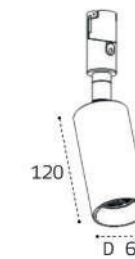
Светодиодный светильник 3W / 3000K / 149 lm 48V / 180° / Ra>90 Цвет: черный, матовый рассеиватель
